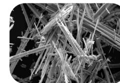
Réaliser des travaux sur des matériaux amiantés **libère des fibres** dans l'air et génère un risque pour les personnes réalisant les travaux ou à proximité.
