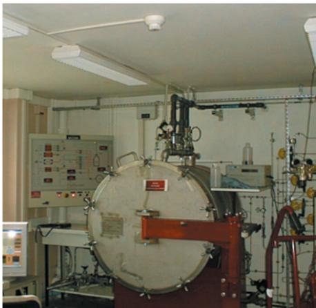
*Banc d'étalonnage radon de l'IRSN.*
