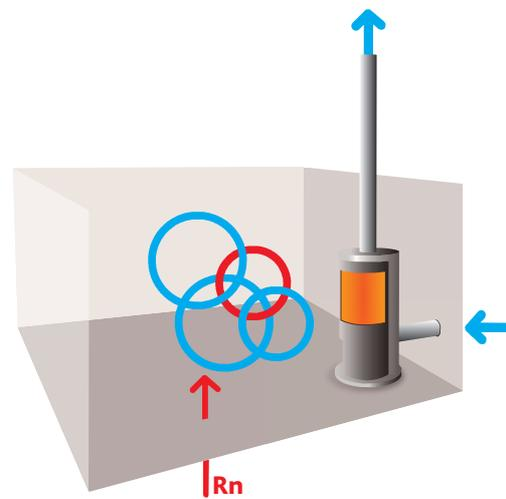
**Chauffage en marche avec une entrée d'air spécifique à la combustion.**
