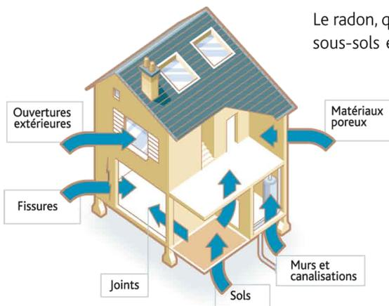
Le radon, qui s'accumule dans les sous-sols et les vides sanitaires, entre dans les maisons par différentes voies (fissures, passages de canalisation, etc.).
